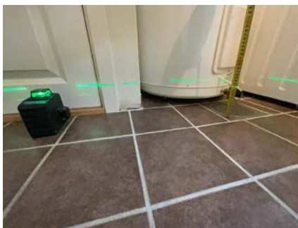
Avvik høydeforskjell fra gulv ved dør til sluk.
