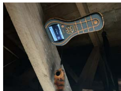
Ingen utslag på unormale fuktverdier på tilgjengelig sjekket sted.
