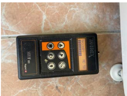
Fuktslag på søkefunksjon
