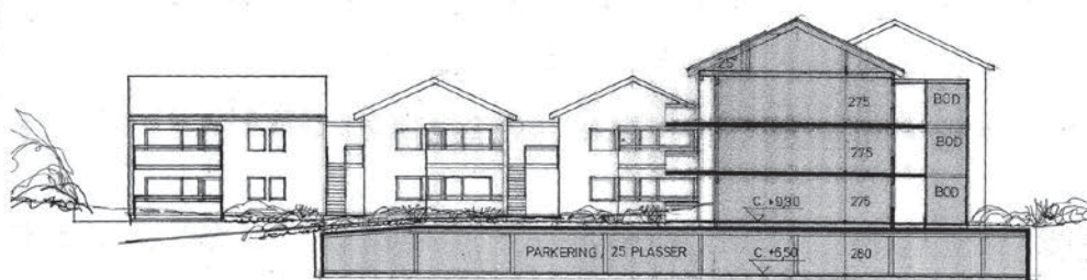
SNITT 1-1 m/OPPRISS MOT SÖR, MÅL 1:200
