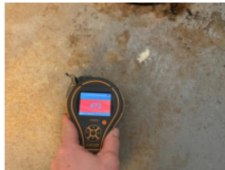
Høye fuktverdier i ytterveggene.
