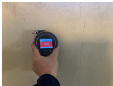
Høye fuktverdier i ytterveggene.
